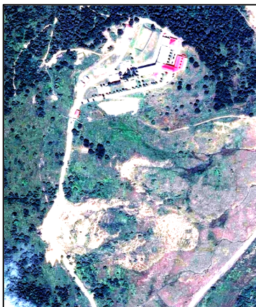
Рис. 2. Космический снимок оползневого участка на левом борту р. Артаваз-1; стенка срыва крупного оползня совпадает с подрезкой склона и прокладкой автодороги.
