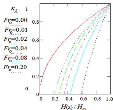
Рис. 3. Коэффициенты трансформации длин волн в зависимости от относительных глубин взморья и чисел Фруда встречного речного потока, заданных в сечении взморья с глубиной  $H_0$
