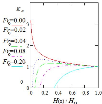
Рис. 2. Коэффициенты трансформации амплитуды длинной волны в зависимости от относительных глубин и чисел Фруда встречного речного потока, заданных в сечении взморья с глубиной  $H_0$
