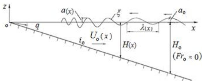
Рис. 1. Расчетная схема трансформации длинных волн в приустьевом взморье
