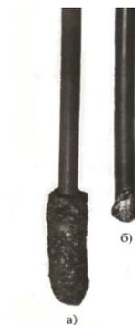
Рис. 1. Образцы дисилицида молибдена после выдержки их в жидком железе
