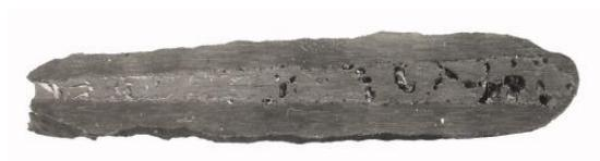
*Рис. 3. Фотография разреза дисилицида молибдена после выдержки в жидком железе в течение 5 с*
