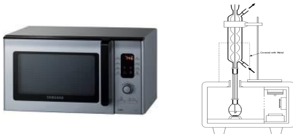
Рис. 1. Бытовая микроволновая печь марки CE1073AR фирмы “Samsung”, переделанная для проведения химических процессов
