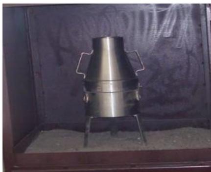
*Рис. 1. Лабораторная СВС установка*
