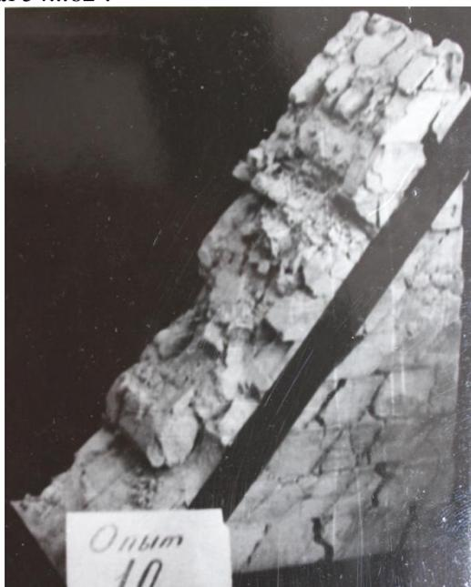
*Рис. 1. Направленный срез структурной модели, состоящей из блоков неправильной формы*
