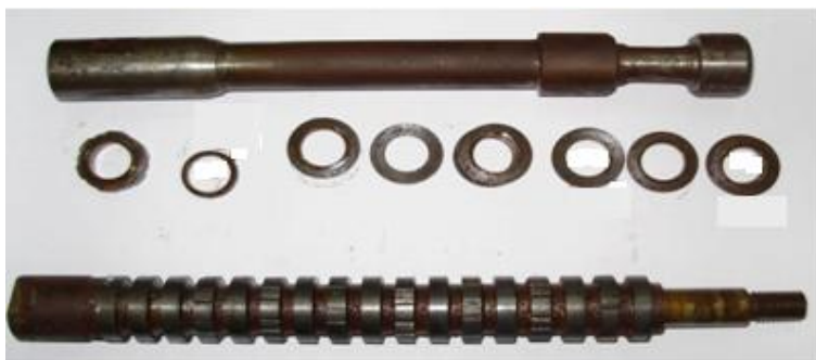
Рис. 1. Механическая круглая протяжка со сменными кольцами и оправами
