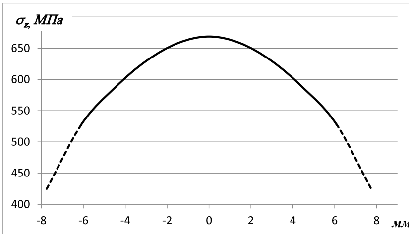
Рис. 8. График \sigma_z - r в случае перемещения концов образца 6 мм (радиус в наименьшем поперечном сечении шейки образца равен \approx 8 мм)
