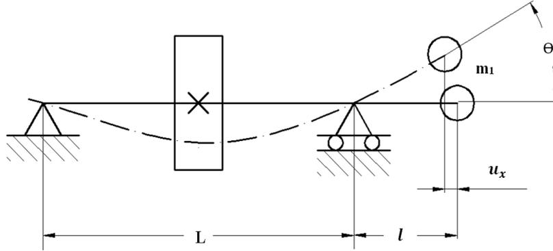
Рис. 2 Вращающийся гибкий ротор, закрепленный одним концом с сосредоточенными массами в середине пролета и на свободном консольном конце
