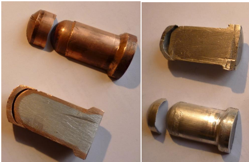
Рис. 9. Разрезанные прессовки, полученные при прессовании с большим противодавлением с различным сочетанием подкладки, кожуха и сердечника
