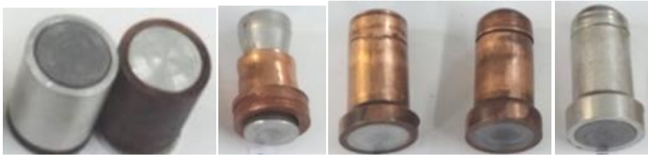
Рис. 8. Образцы и прессовки, полученные прессованием с различными противодавлениями. Темным сердечникам соответствует материал из свинца
