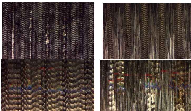
Рис. 8. Обработанные методом УЗ резания поверхности (слева) и те же поверхности после тонкого шлифования и хонингования
