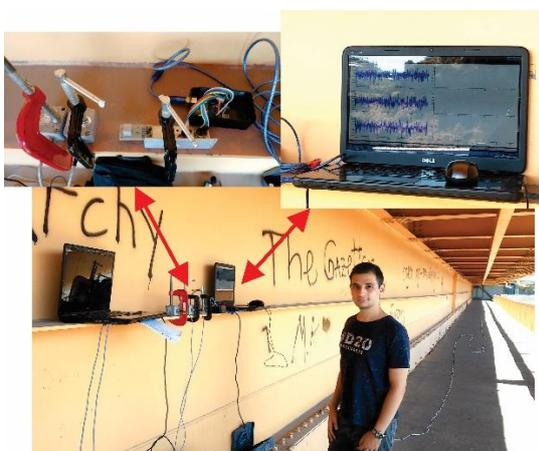
*Рис. 4. Установленные на Давидашенском мосту акселерометры BS и MPU6050*
