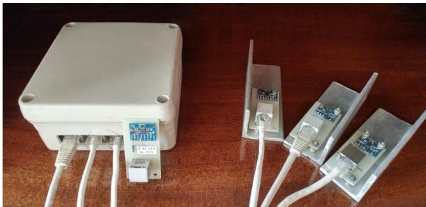
**Рис. 2. Разработанный на базе акселерометра MPU6050 комплекс для измерений ускорений колебаний**
