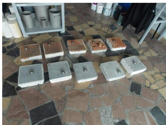
**Рис. 3. Образцы, к которым специальным полимерным клеем приклеены металлические диски**
