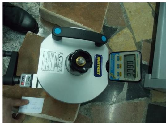
**Рис. 4. Отрыв дисков через 24ч. для определения прочности на отрыв в сухом состоянии**
