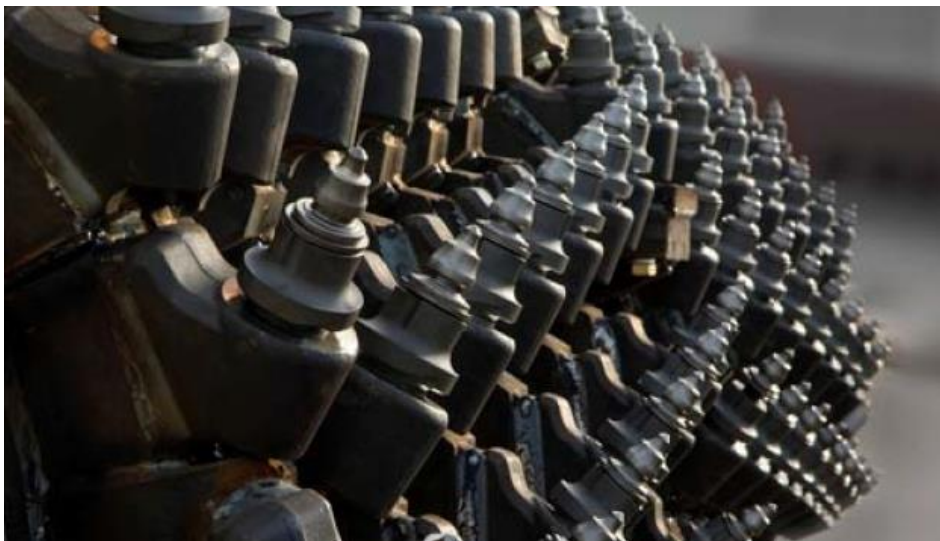
Նկ. 4. Մանր ատամիկներով միկրոֆրեզման թմբուկ (micro-milling drum)
