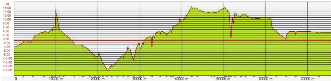
Նկ. 4. Պոլիգոնի I դասի նիվելիրային ընթացքների I և III փուլերի հավասարակշռված հենանիշերի տարբերությունների երկայնական կողապատկերի սխեման
