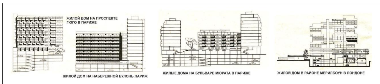
Рис. 2. Использование подземного пространства жилых домов для различных функций
