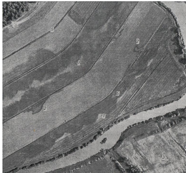
Рис. 2. Зависимость тона фотоизображения от влажности почвы и степени смывости: 1 – участки пашни после полива, 2 – понижение на пашне, 3 – смыв почвы, 4 – промоины, 5 – каналы
