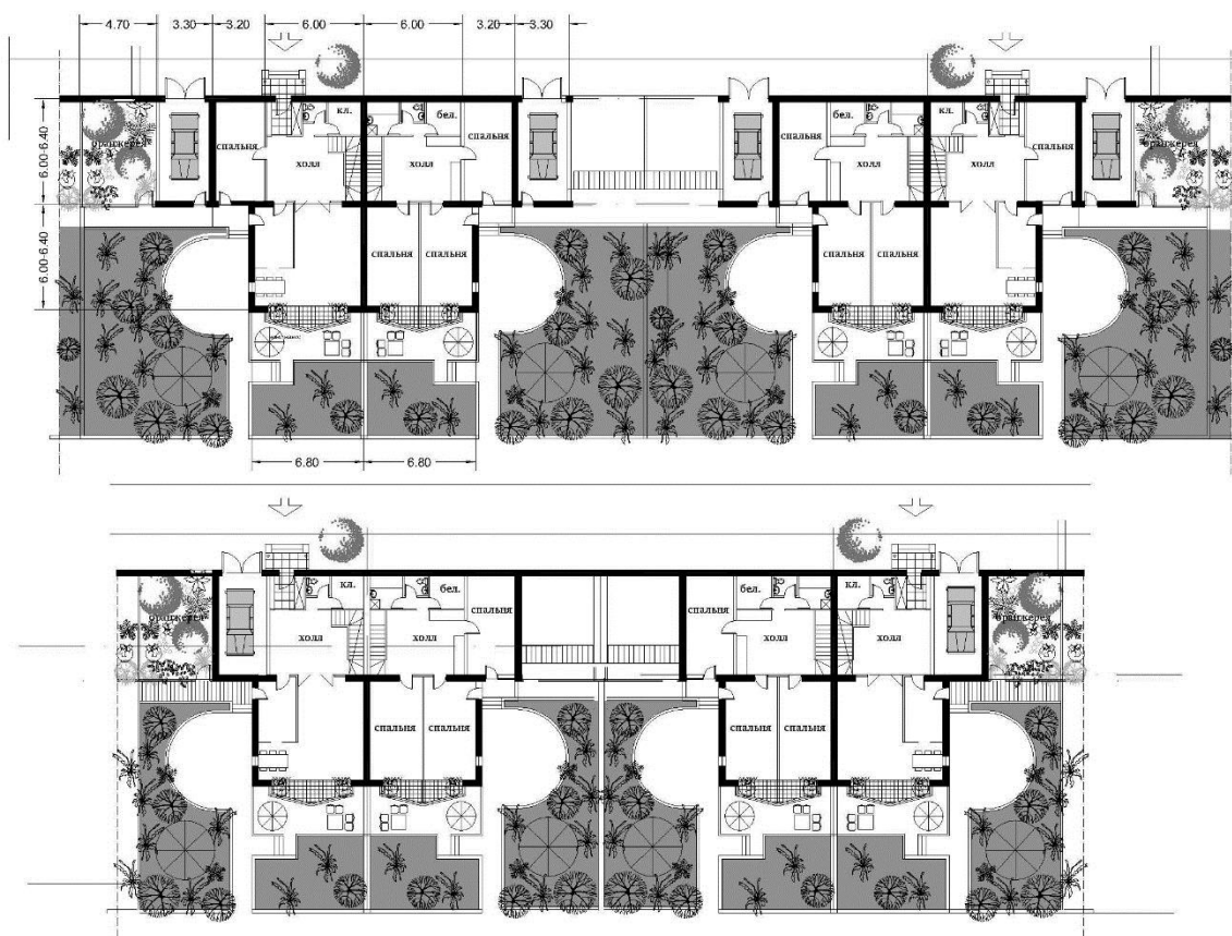
Рис. 2 Предложения по архитектурно-планировочному решению солнечных малоэтажных домов индивидуального строительства, спаренных двухквартирных типов (на 4-5 комнат) на двух уровнях с пассивной системой для застройки на участок с небольшими уклонами, с входом и гаражом с нагорной стороны.
