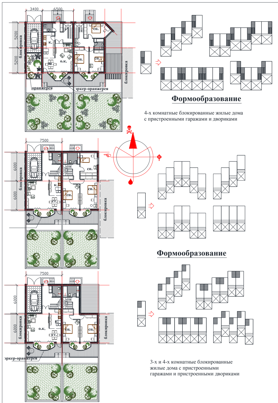
Рис.2. Планировочные решения 2-х этажных блокированных типов жилых домов с квартирами на двух уровнях с гаражами и пристроенными двориками
