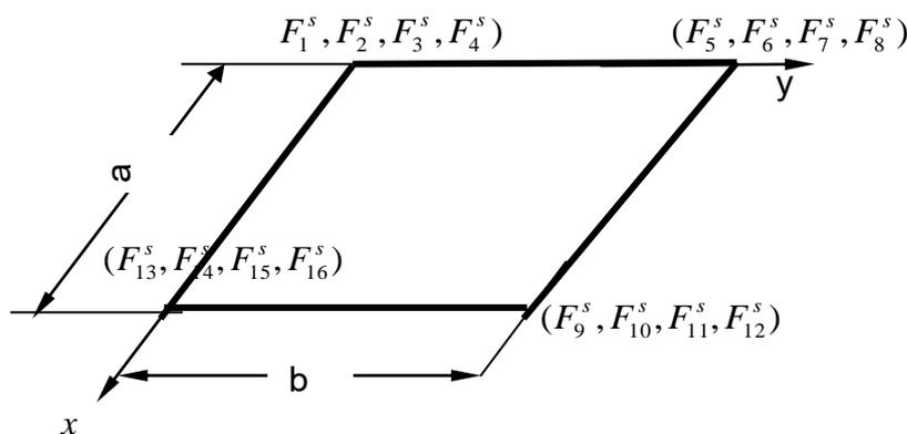
Рис. Схематическое изображение прямоугольного конечного элемента пластины
