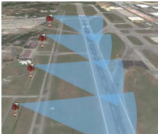
Նկ. 3. Թռիչքային գոտու վրա զննող սարքավորման տեղադրումը թռիչքային
