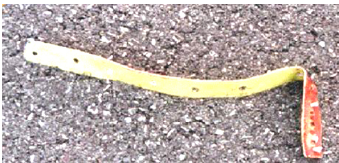
Նկ. 1. Էիր Ֆրանս Կոնկորդ օդանավի վթարի պատճառ հանդիսացած մետաղական տարրը
