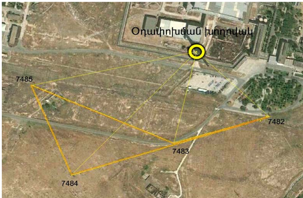
Նկ. 1. ՀՀ ԱԷԿ-ի օդափոխման խողովակի կողաթեքման ձևախախտման դիտարկման սխեման
