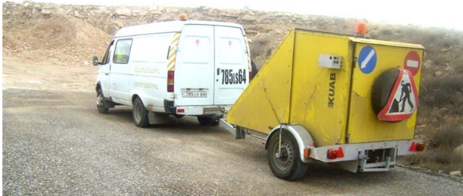
Նկ. 5. Դաշտային լաբորատոր փորձարկում KUAAB FWD ձկվածքաչափով
