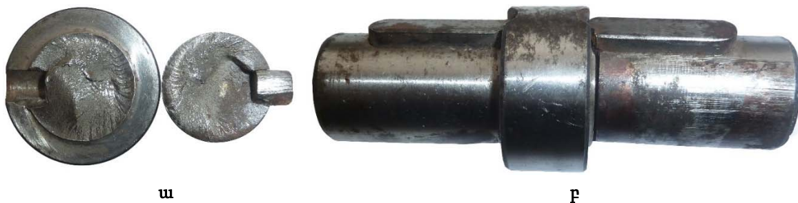
Նկ. 3. Երիթային միացության հոգնածային կոտրվածքը համատեղ պտտական ծռման և ոլորման դեպքում. ա – տեսքը լայնական հատվածում, բ – կոտրվածքի տեղաբաշխումը լիսեռի վրա
